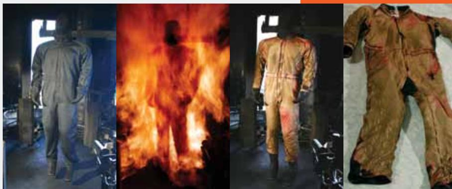
Thermo-Man® — это манекен в человеческий рост, оснащенный 122 термодатчиками. В ходе испытаний на манекен надевается защитная одежда, после чего он подвергается воздействию пламени. Thermo-Man®, моделируя реакцию кожи человека, позволяет прогнозировать:
